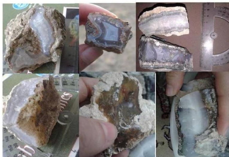
Figure 5. نمونه‌های مشاهده شده از دو نوع کانی‌زایی پرکننده‌ی حفرات و پرکننده‌ی درزه‌ها
