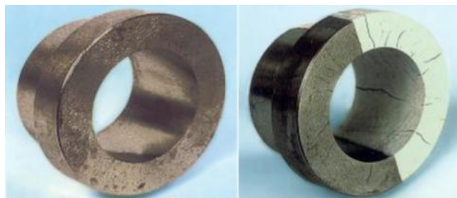
شکل ۱- نشانه های ظاهر شده بر روی قطعه در آزمون مایع نافذ
