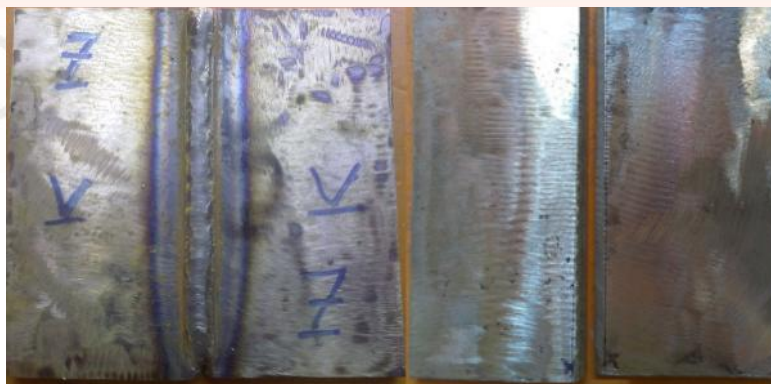
شکل ۲- نمونه قطعات تهیه شده قبل از جوشکاری
