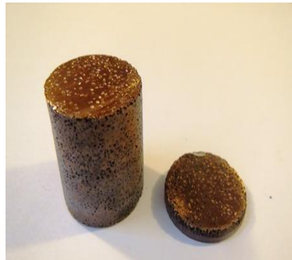
شکل ۶. تصاویر ماکروسکوپی و میکروسکوپی فوم نانو کامپوزیتی مس- آلومینا.
