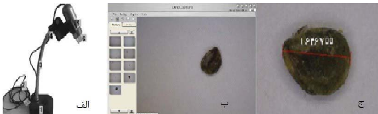
شکل ۲- الف: بیناکولر. ۱: پایه ۲: کابل رابط ۳: پایه فنی ۴: پایه نگهدارنده میکروسکوپ جهت تثبیت آن. ۵: پیچ بزرگ نمایی. ۶: محفظه نورپردازی یکنواخت با استفاده از ۸ عدد لامپ. ب: عکس گرفته شده از نمونه با بیناکولر و محیط نرم افزاری دینو کپچر. ج: اندازه گیری طول نمونه توسط نرم افزار بر حسب میلی متر
