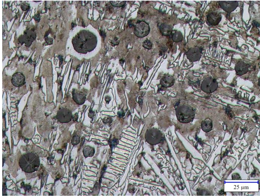
شکل ۶. تصویر میکروسکوپ نوری بعد از اچ در بزرگنمایی ۵۰۰ برابر از نمونه حاوی گوی‌هایی با قطر ۴ mm
