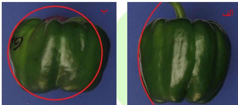
شکل ۷. دو نمونه از تطابق شعاع انحنا بدست آمده به روش پردازش تصویر بر روی فلفل دلمه
