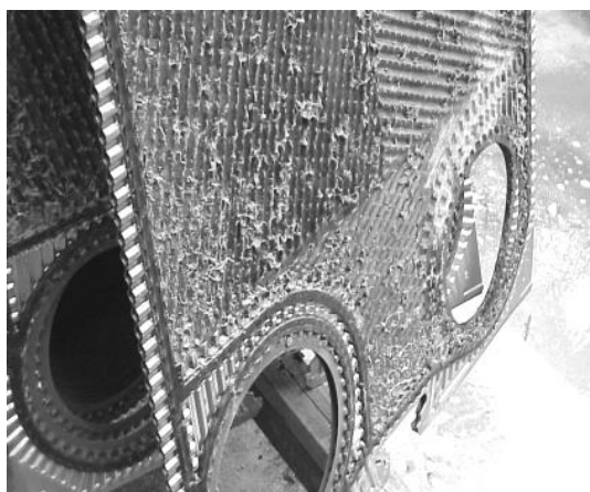
شکل ۳. رسوب در مبدل حرارتی صفحه‌ای [۱۰]
