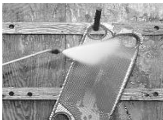
شکل ۶. تمیز کردن مبدل باز شده [۱۰]
