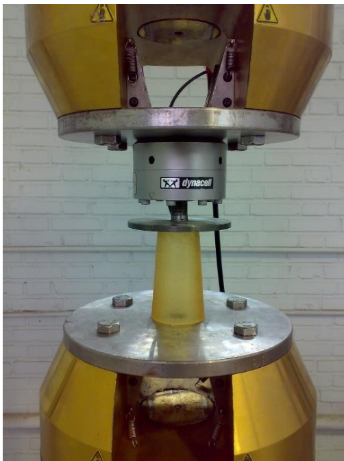
شکل ۱: نمونه کامپوزیتی تحت آزمایش جذب انرژی.
