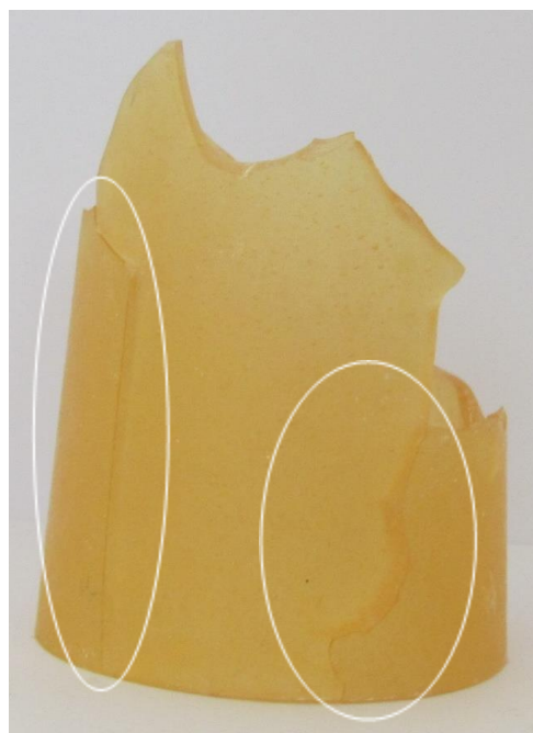
شکل ۳: شکست ترد نمونه بر اثر ترک‌های محوری.
