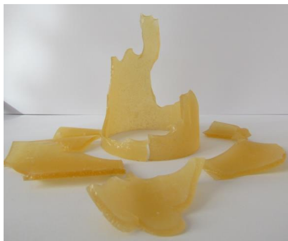
شکل ۴: جدا شدن تکه‌های بزرگ در راستای ارتفاع بر اثر رشد ترک‌های محوری.
