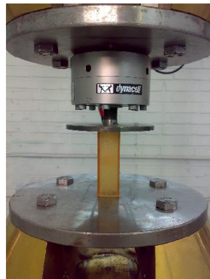
شکل ۱- نمونه کامپوزیتی تحت آزمایش جذب انرژی.
