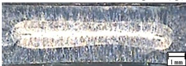
شکل ۲: ماکروساختار سطح مقطع عرضی یک نمونه جوشکاری شده
