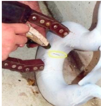
شکل - نشانه های ظاهر شده بر روی قطعه در آزمون ذرات مغناطیسی
