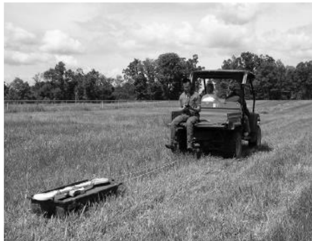
شکل ۲- دستگاه EMP-400 مجهز به GPS [دولتیل و بریویک، ۲۰۱۴]
