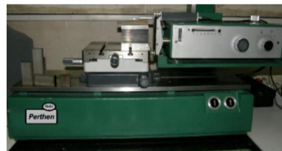
شکل 4 دستگاه زبری سنجی نمونه‌های آزمایش
