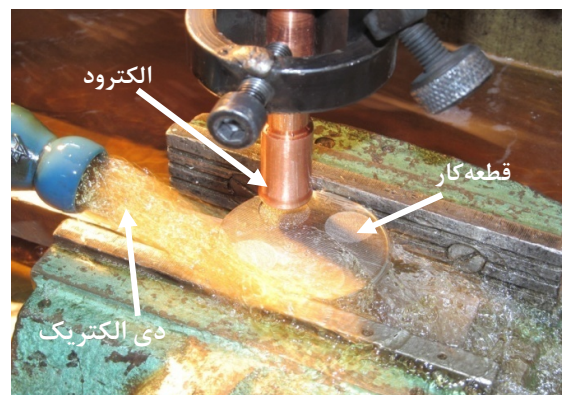
شکل ۳. الکتروده و قطعه کار مورد استفاده در انجام آزمایشات
