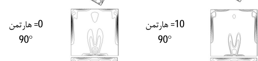
شکل 8 کانتورهای تولید آنتروپی کل در عدد رایلی 10^6 ، زوایای انحراف مختلف و اعداد هارتمن مختلف (نانوسیال آب - آلومینا، 5%).
