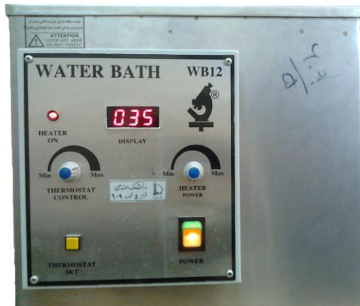
شکل ۲. حمام آب مورد استفاده برای تست دما بر روی ویسکوزیته
