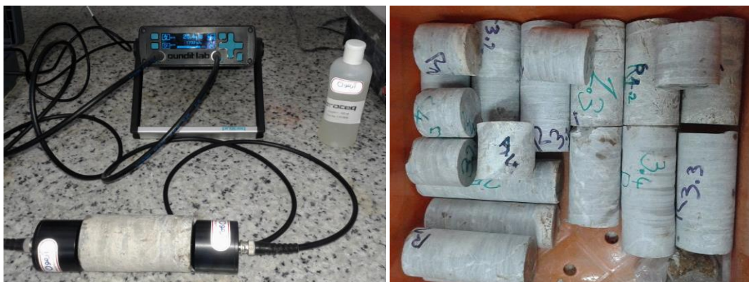
شکل ۲. مغزه‌های آزمایش سرعت موج P (راست) و دستگاه آزمایش به همراه نحوه اتصال مغزه به دیوسرها
