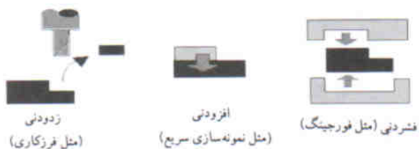
شکل ۱. روش‌های کلی شکل‌دهی مواد.
