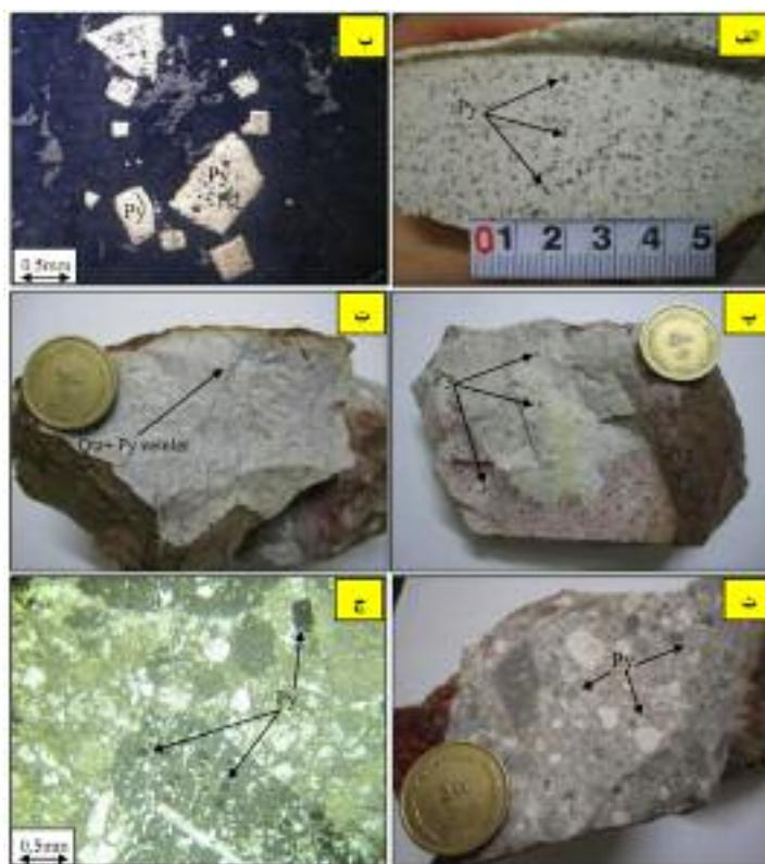
شکل ۹ الف. نمونه‌ی دستی **دایک** گرانودیوریت پورفیری دارای کانی‌سازی پیریت به صورت پراکنده و ب. مقطع میکروسکوپی **دایک** گرانودیوریت پورفیری (نور بازنایی)، ب. ریوداسیت دارای کانی‌سازی پیریت به صورت پراکنده، ت. ریوداسیت دارای رگچه کوارتز + پیریت، ث. نمونه‌ی دستی از برش گرمابی پلی مکتیک دارای کانی‌سازی پیریت هم در قطعات، ج: مقطع میکروسکوپی از تصویر ث (نور XPL). Py: پیریت.
