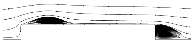
شکل (۷): خطوط جریان گذرنده از استوانه در امتداد محور طولی ناشی از حل عددی انجام شده.
