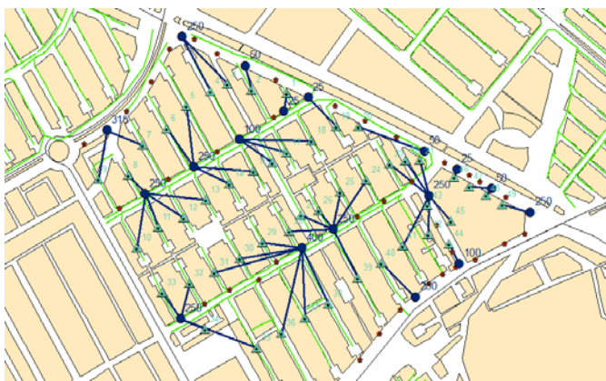
شکل ۶: ظرفیت و محل ترانسفورماتورها در مطالعه ۱-۱
