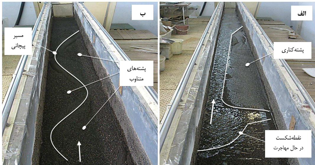
شکل ۴-الف- توسعه پشته کناری در پایین دست نقطه شکست (ساعت سوم آزمایش شماره ۱)
