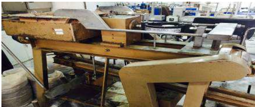
شکل ۲- دستگاه برش مستقیم استاندارد ۳۰*۳۰
