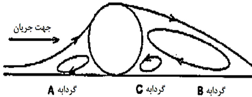
شکل ۱- سه گردابه تشکیل شده اطراف لوله (چیو، ۱۹۹۰)
