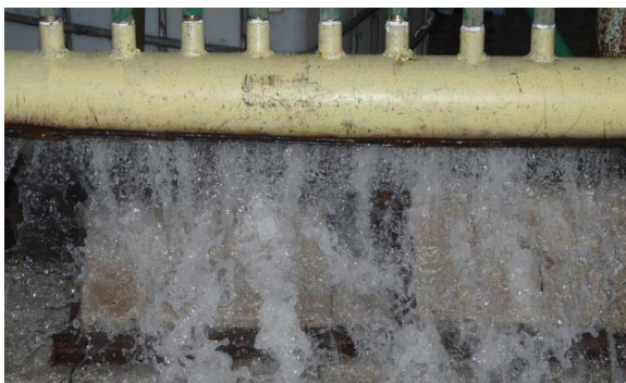
شکل ۹- نمایی از سازه جت آب صفحه‌ای و چیدمان نمونه‌ها در زیر آن
