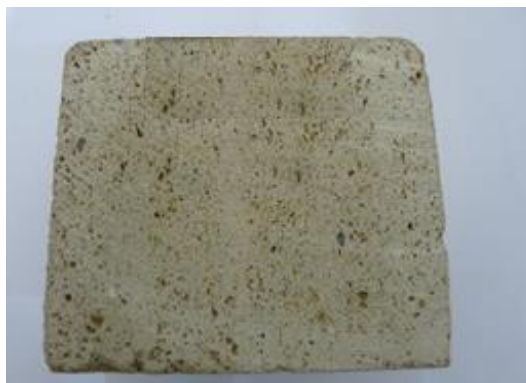
شکل ۱۰ - فرسایش ایجاد شده بر روی نمونه خاک
