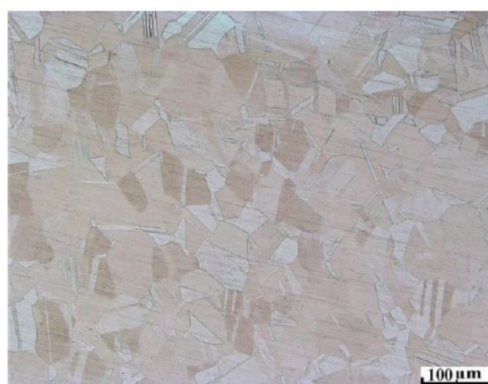
شکل ۳ - ریزساختار بدست آمده از میکروسکوپ نوری نمونه‌ی پاس صفر (مس تابکاری شده).
