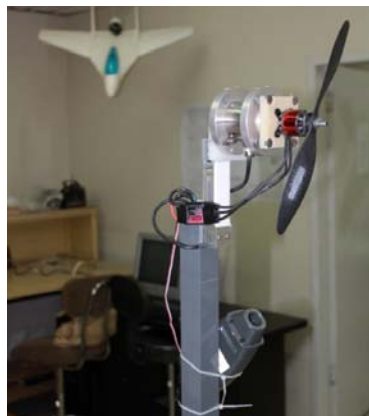
شکل ۳- دستگاه اندازه‌گیری پارامترهای مجموعه پیشرانس ساخته شده در آزمایشگاه ریزپهپاد ۱
