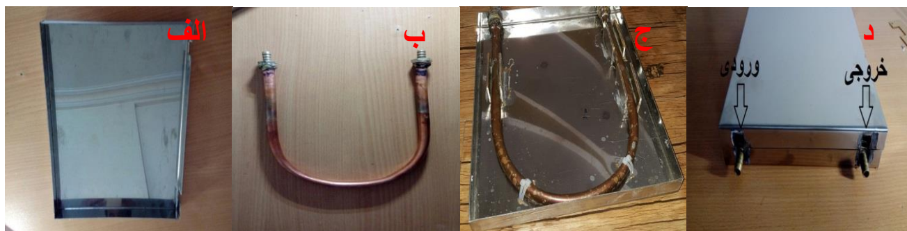
شکل ۵ اجزای تشکیل دهنده دستگاه مغناطیس‌کننده آب. الف) فریم استیل ب) لوله مسی ج) مگنت نئودیمیوم بر روی لوله مسی د) شکل نهایی دستگاه مغناطیس‌کننده آب
