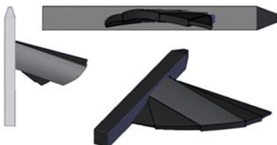
شکل ۵- سه نما از طرح مفهومی پهناد دارای مکانیزم RTM
