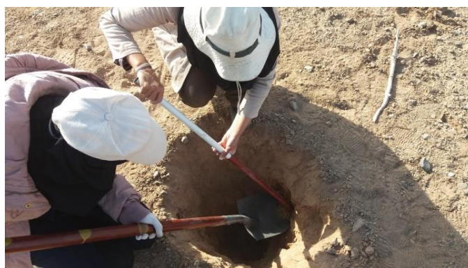
شکل (۲): نمونه برداری از پروفیل داخل بندسار
