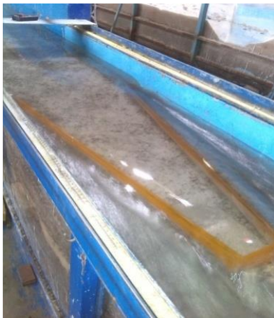
شکل ۱۵- جریان در H/P=0.3, L/W=4, P=6 \text{ cm}, D=6 \text{ cm} (بدون هوا)
