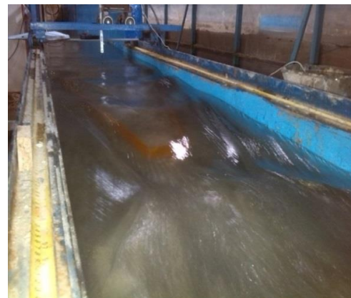
شکل ۱۶- اثر تداخل جریان و استغراق در H/P=1.65 ، D=6\text{ cm} و P=6\text{ cm} ، L/W=4 با ضریب دبی 0.26 و دبی Q=59\text{lit/s}
