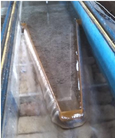
شکل ۱۴- جریان در H/P=0.3, L/W=4, P=6 \text{ cm} , D=15 \text{ cm} (هوادر)
