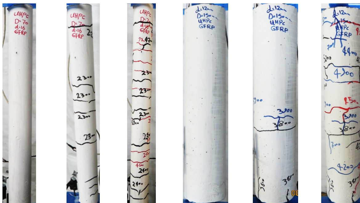
شکل ۱۲: الف: مراحل پیدایش ترک برای نمونه 150-12-GFRP1
