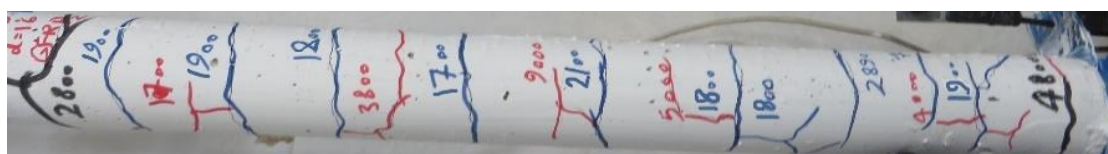
الف- ترک خوردگی در نمونه مورد آزمایش
