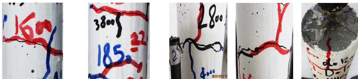
شکل ۱۱: الف: بازشدگی ترک‌ها برای نمونه 100-12-GFRP1
