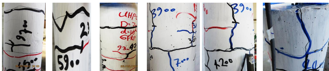
شکل ۱۳: الف: بازشدگی ترک‌ها برای نمونه 150-12-GFRP1
