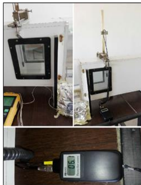
شکل ۶: نمایی از دستگاه ترمو-آنیومتر و حسگر آن
