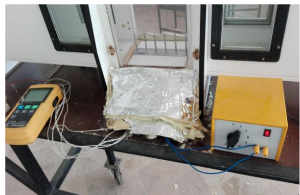
شکل ۹: نمایی از نمونه مورد آزمایش در داخل تونل باد
