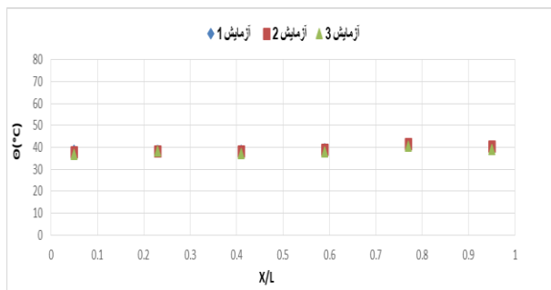
شکل ۱۰: تغییرات \theta طرح ۷ برحسب موقعیت به ازای سرعت هوا ۲ متر بر ثانیه در سه آزمایش مختلف
