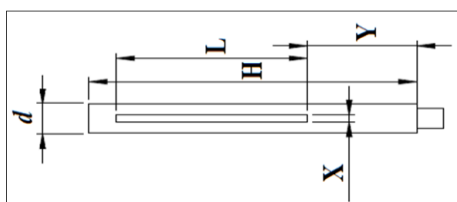
شکل ۱: نمایی از پره سوزنی شیاردار با ابعاد L و Y , X , d , H و L
