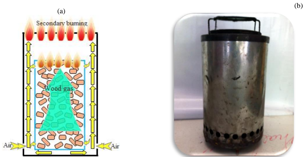
شکل ۱- اجاق زیستی ساخته شده (b)؛ طرح‌واره فرآیند کاری اجاق (a) Fig. 1. The manufactured stove (b); and the schematic of the process (a)
