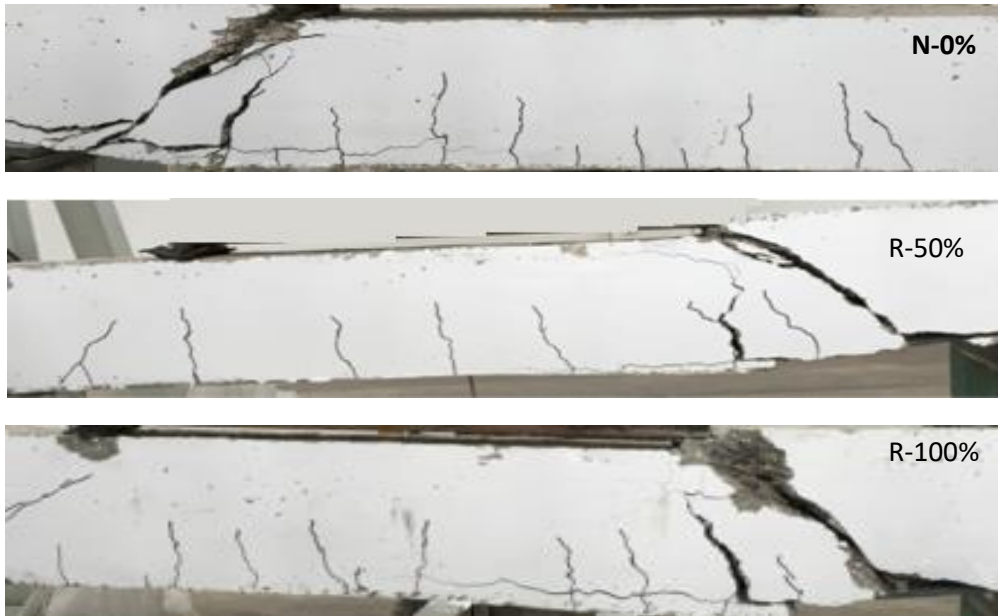
شکل ۴- ترک خوردگی و مسیر گسترش ترک‌ها
