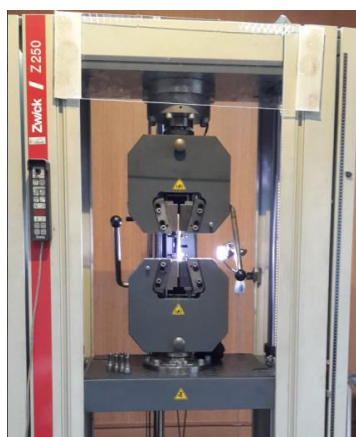
شکل ۲- آزمایش کشش مستقیم میلگرد
