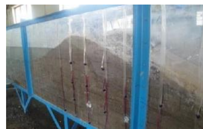
شکل ۱- وضعیت قرارگیری پیزومترها Figure 1- Experimental Flume and Pizometer
