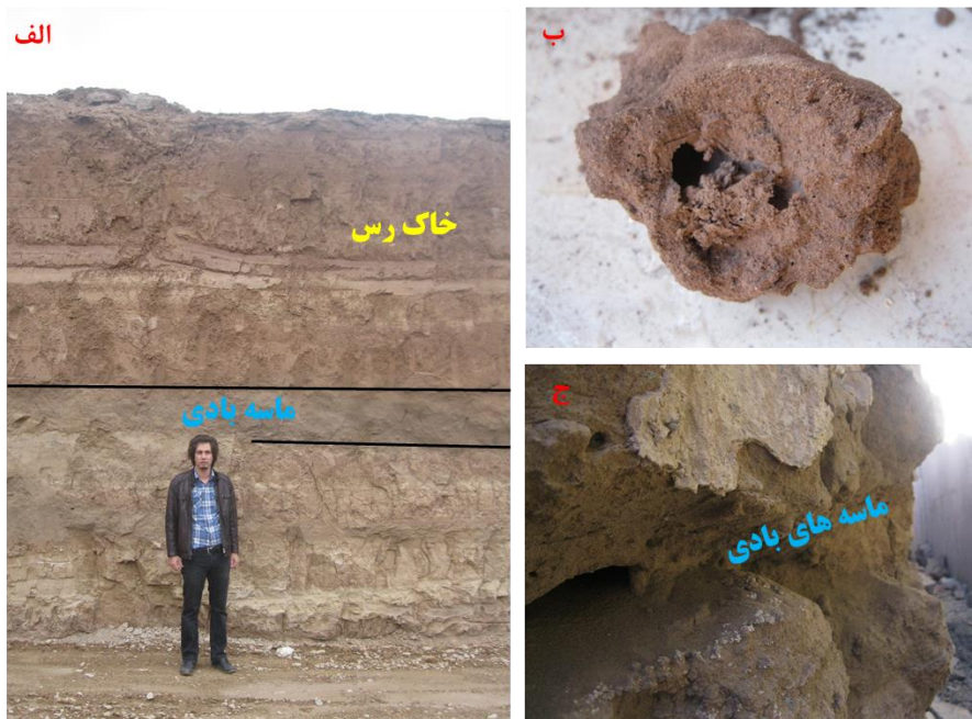
شکل ۱۳. الف) توالی رس و ماسه بادی خیابان وصال ب) نمونه خاک کاملاً رَمبند گرفته شده از عمق ۲ متری شهرک پدرج) وجود لایه های ماسه های بادی کاملاً ناپایدار در اعماق ۱ متری واقع در خیابان هلال احمر
