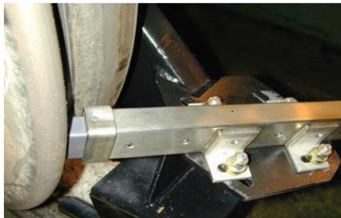
شکل ۴- روانکار جامد فلنچ چرخ [۱۰]
