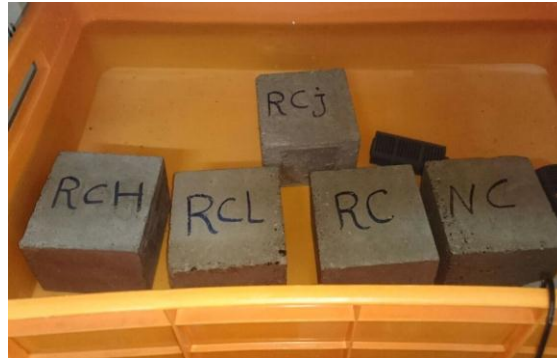
شکل (۳) ظرف قرارگیری نمونه‌ها در آزمایش جذب آب
