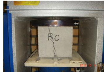
شکل (۵) شکست نمونه
