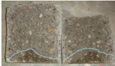
شکل (۶) پروفیل عمق نفوذ آب (RC)
