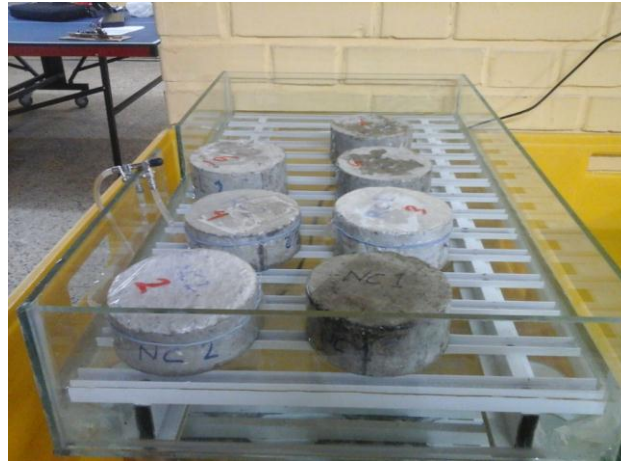
شکل (۴) تشتک قرار گیری نمونه‌ها آزمایش جذب آب موئینه
