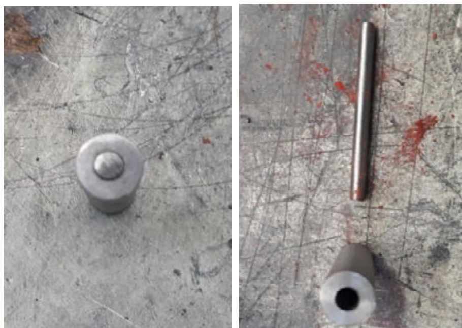
شکل 1: (a) شماتیکی از تصویر غلاف فلزی از جنس CK45 (b) نمونه قرار داده شده در غلاف.
