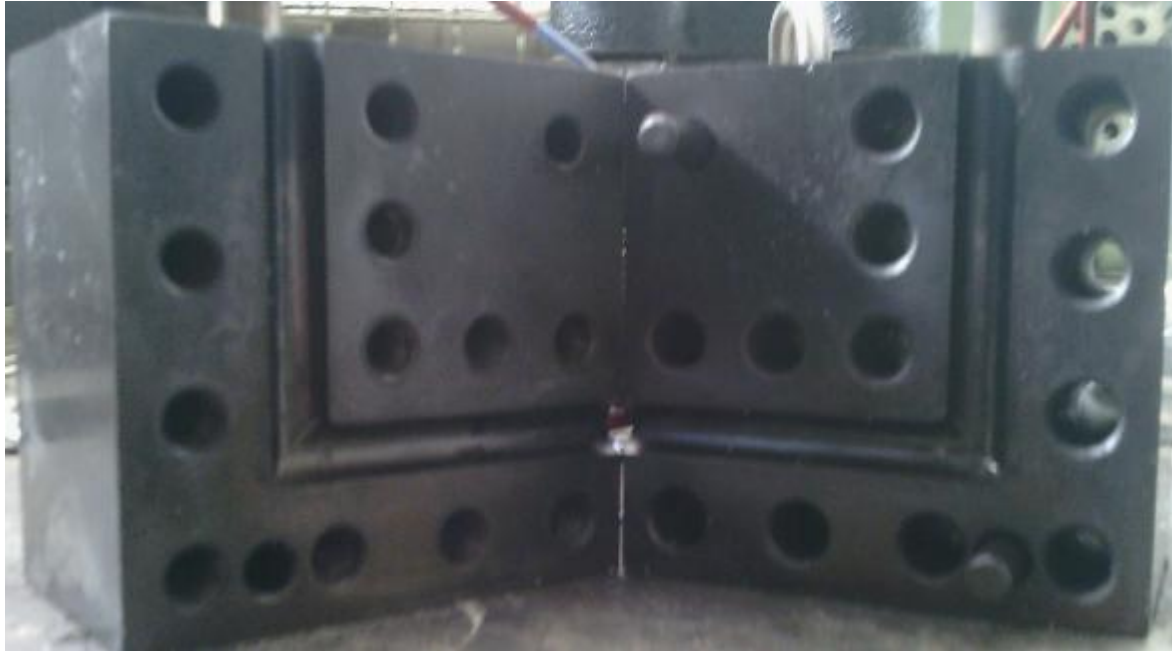
شکل 2: نمایی واقعی از درون قالب ایکپ مورداستفاده.
