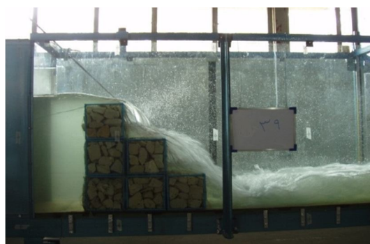
شکل 9- نمونه آزمایش بر روی مدل سرریز پلکانی گابیونی بدون رسوب
