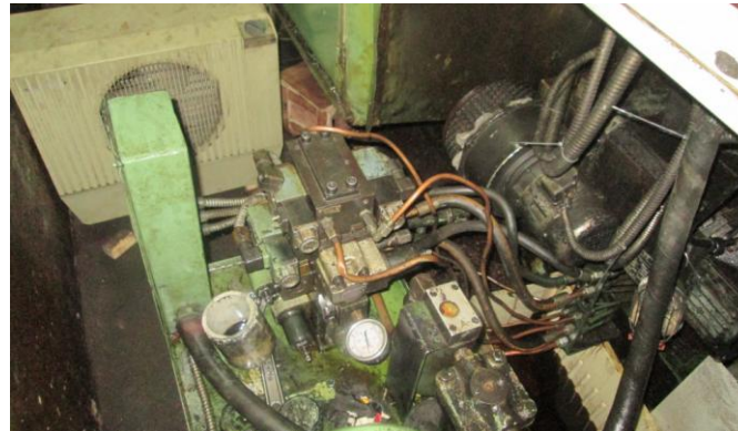
شکل ۱ - نمای ظاهری سیستم هیدرولیک در ماشین تراش CNC
