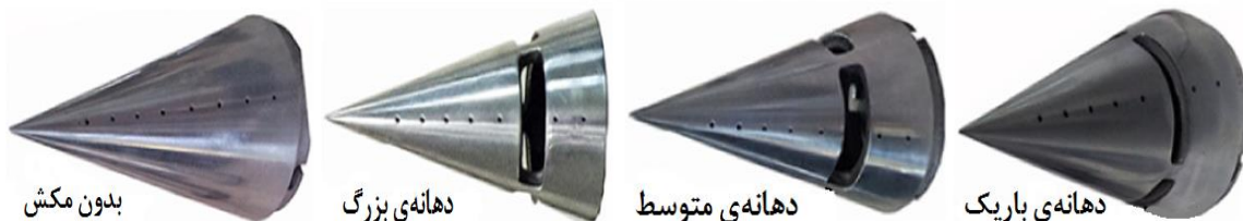
شکل ۴- دماغه‌های استفاده شده در این پژوهش به همراه پارامترهای هندسی آن
