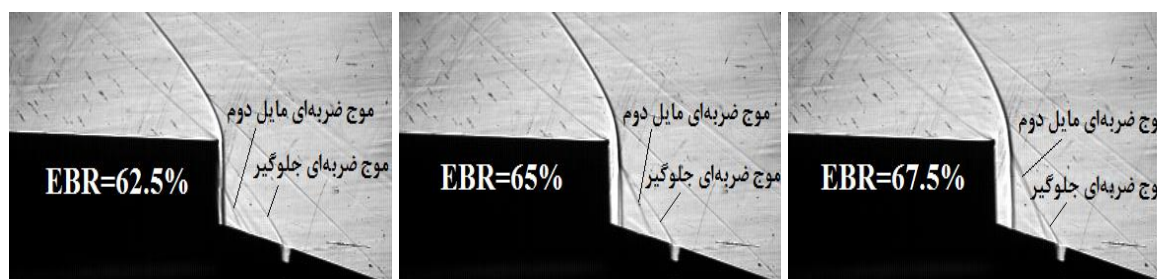
شکل ۱۰- تصاویر سایه‌نگاری برای دماغه‌ی یک در سه نسبت انسداد مختلف
