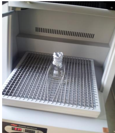
شکل ۲. شیکر-انکوباتور مورد استفاده برای رشد باکتری
