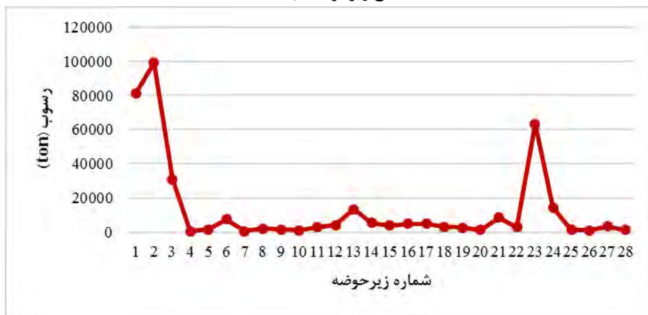
شکل ۴. میزان رسوب در هر یک از زیر حوضه های حوضه سد فریمان بر اساس شاخص اثر بار کل رسوب
