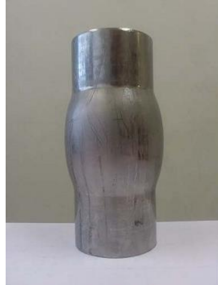
شکل ۵- نمونه‌ی آزمایش شده در فشار ۳۰ مگاپاسکال [4]
