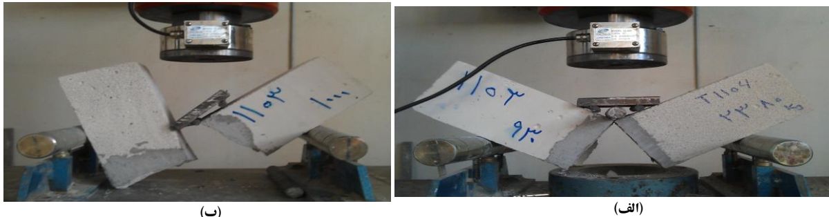
شکل ۱۲- آزمایش روند کسب مقاومت چسب بلوک (الف) نمونه 2P20-72h-2 (ب) نمونه 2P20-336h-2
