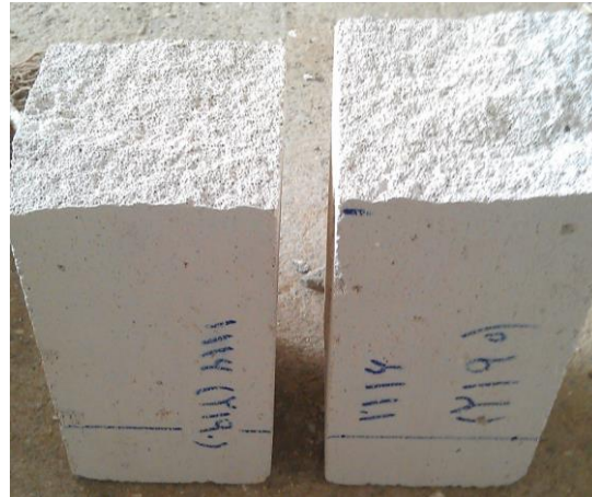
شکل ۱۰- سطح شکست نمونه 1P40-1 تحت خمش سه نقطه‌ای
