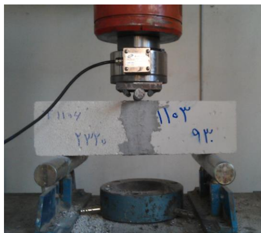
شکل ۱۱- نمونه آزمایش روند کسب مقاومت چسب بلوک تحت خمش سه نقطه‌ای (1P20-72h-1)
