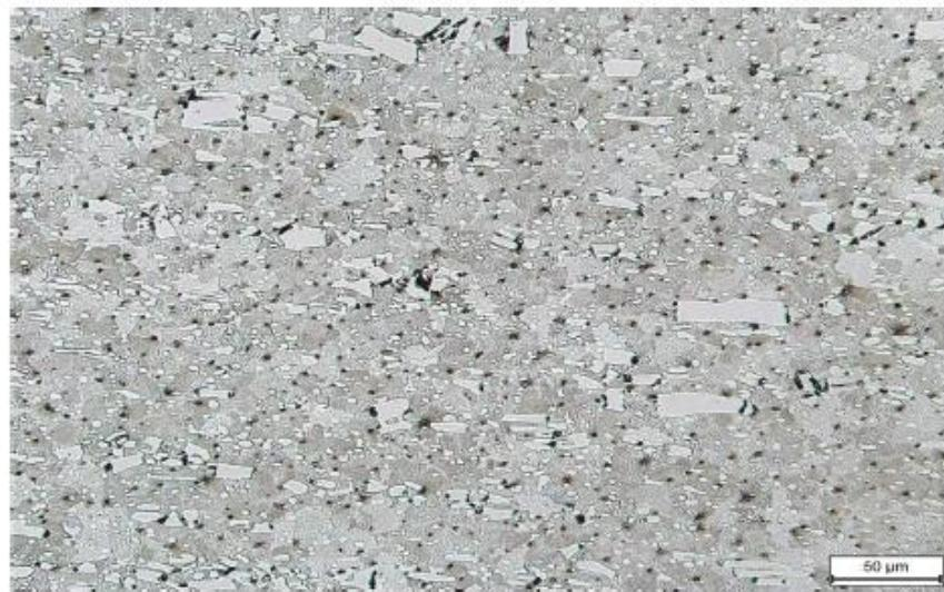
شکل ۴. تصویر میکروسکوپ نوری نمونه گرافیت زایی ۱۰ ساعت با زمینه آستینی.
