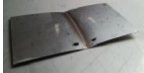
نمونه ورق AISI 304 جوشکاری شده در تحقیق حاضر
