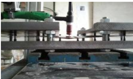
انجام عملیات جوشکاری بر روی یک نمونه آزمایش در فیکسچر جوشکاری
