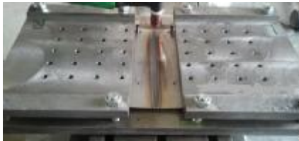
فیکسچر جوشکاری ساخته شده به همراه ورق کارگیری شده در آن
