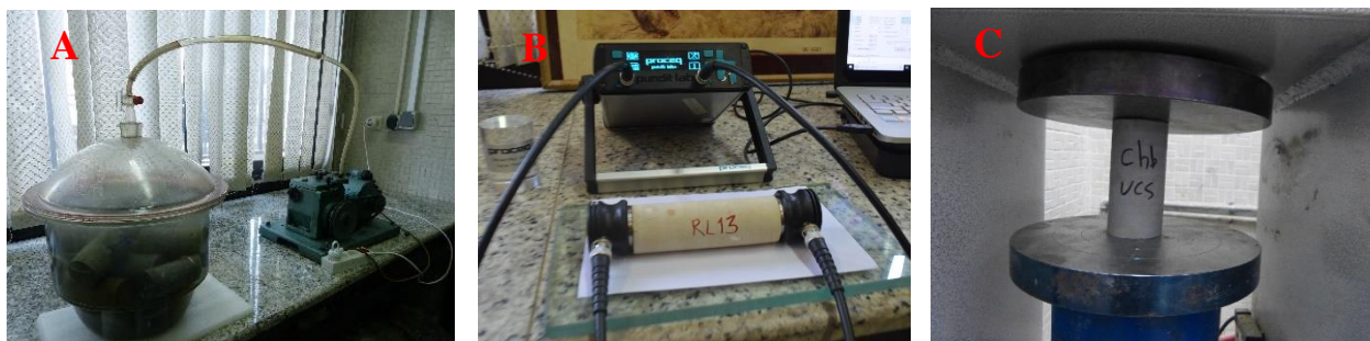
شکل (۲): اشباع کردن نمونه‌ها در شرایط خلا (A)، تعیین سرعت موج تراکمی و تعیین مقاومت فشاری تک محوری (C).
